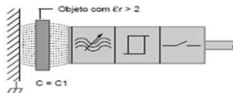
Figura (3) - Funcionamento do sensor capacitivo.
