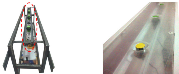
Figura (8) - Suporte para fixação dos sensores e Placa de acrílico com orifícios.
