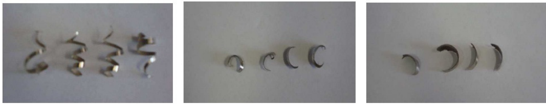
(a) V_c = 160 m/min. + e = 0,08 mm/dente (b) V_c = 160 m/min. + e = 0,1 mm/dente (c) V_c = 160 m/min. + e = 0,15 mm/dente
